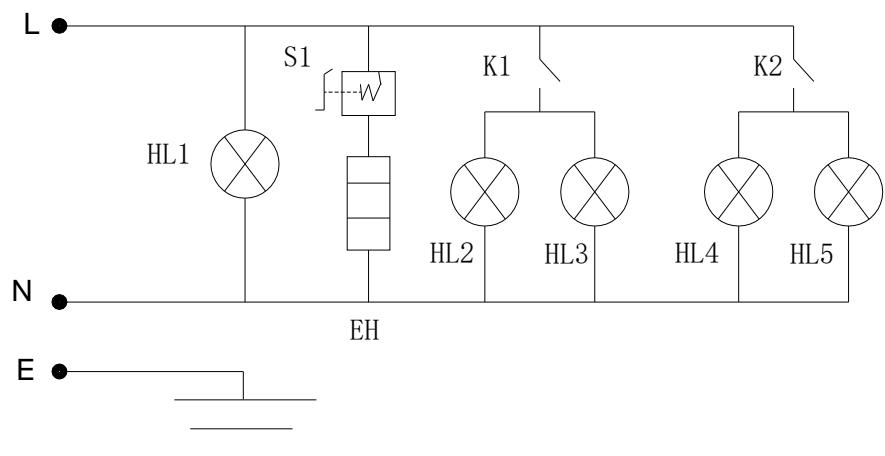
D1-Индикатор питания      R-Трубка нагрева D2,    D3-Светодиодный индикатор
